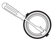
Le déverrouillage de l'adaptateur se fait à l'aide d'un tournevis en poussant le ressort.
